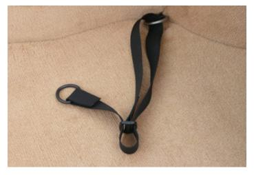
11. INSTALL BOTH STRAPS AS SHOWN. STRAPS ARE NOW READY FOR CARGO-NET ATTACHMENT.
