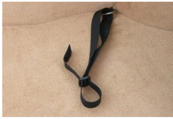
9. INSERT END OF STRAP BACK THROUGH THE PLASTIC SLIDE. MAKE SURE THE STRAP IS POSITIONED AS SHOWN WITH HOOK & LOOP ON THE CORRECT SIDE.
